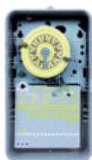
Temporizador mecánico de 24 horas, 120 V CA, 60 Hz, SPST, con caja plástica para interiores/exteriores, intervalo de 1 hora
